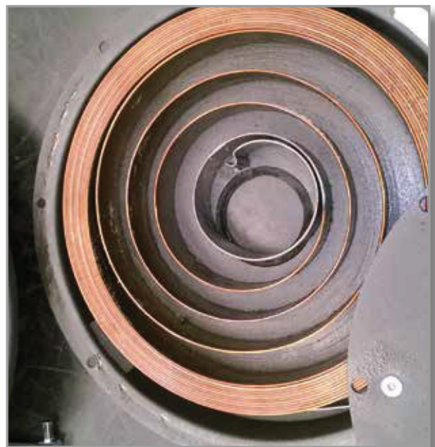
Molla di richiamo in sede protetta Protected recall spring
