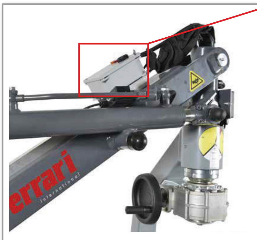
SCHEDA SENSORE DEL LIMITATORE DI MOMENTO SENSOR CARD OF THE LIMITING DEVICE
