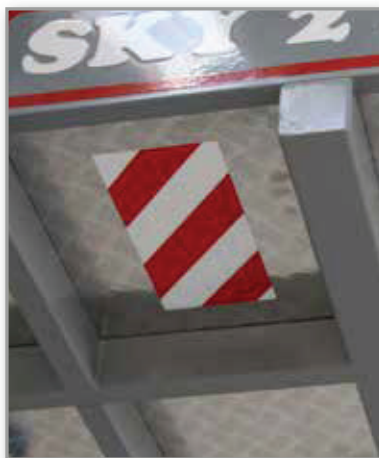
Adesivi catarifrangenti zebrati sotto cestello Reflective adhesive beneath the basket
